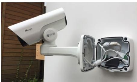
Die Anschlusskabel werden durch die im Wandarm integrierte Anschlussbox innerhalb der Kamera aufgelegt. So benötigen Sie keine externe Verteilerdose, um die Kabel im Außenbereich sicher zu verbinden.
