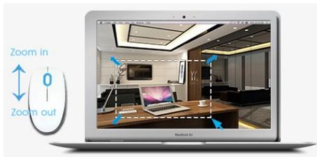
Mit der Funktion 3D Positioning wird das Steuern der Kamera noch einfacher. Sie ziehen einfach mit der Maus ein Feld und die Kamera steuert und zoomt auf diesen Bereich heran. Wenn Sie näher heran wollen oder wieder zurück, können Sie einfach mit dem Mausrad scrollen. Das ermöglicht ein schnelles und flexibles Handeln.
